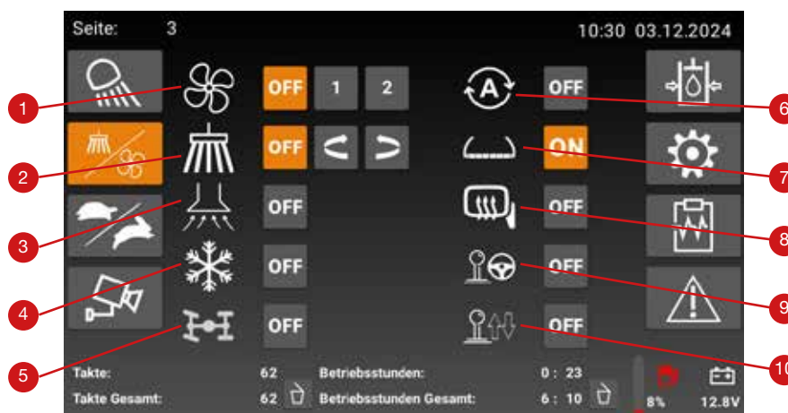
Abb. 20. Steuerung Belüftung / Anbaugeräte
