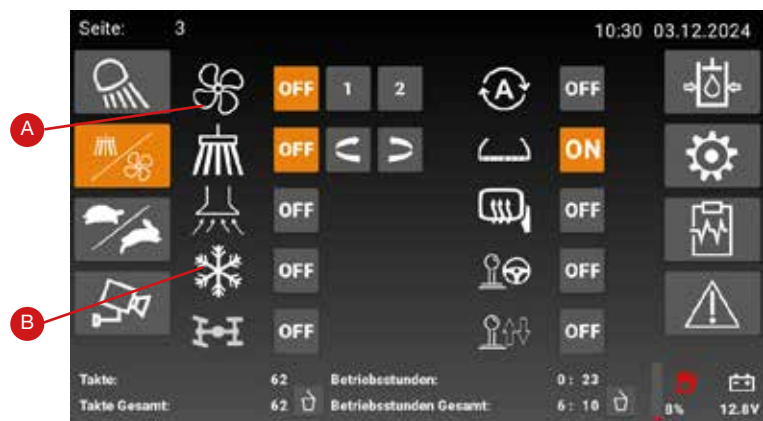
Abb. 16. Steuerung Belüftung / Anbaugeräte
